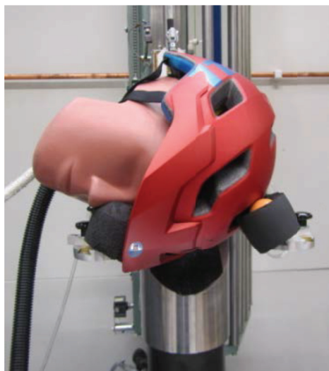
Rys. 4.21. Stanowisko pomiarowe do badań przyspieszeń głowy w przypadku gdy kask zderza się z przeszkodą pod kątem innym niż 90^\circ , wg www.folksam.com
