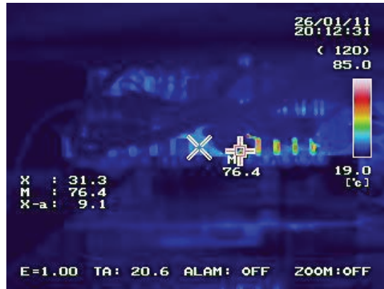
Rys. 2.43. Rozkład temperatury radiatora dla sterowania metodą o zmiennych czasach sygnałów sterujących
