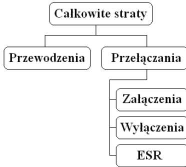
Rys. 2.15. Podział strat w falowniku rezonansowym
