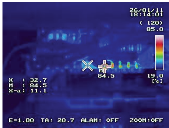
Rys. 2.41. Rozkład temperatury radiatora dla komutacji twardej
