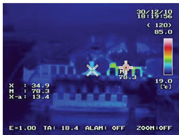
Rys. 3.26. Rozkład temperatury radiatora dla sterowania metodą klasyczną
