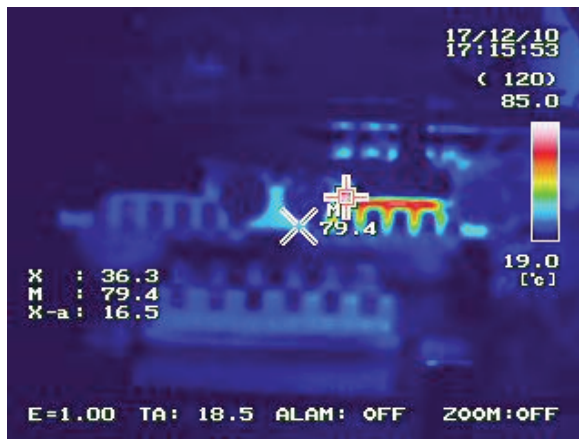
Rys. 3.25. Rozkład temperatury radiatora dla komutacji twardej
