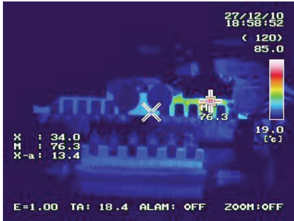
Rys. 3.27. Rozkład temperatury radiatora dla sterowania metodą o zmiennych czasach sygnałów sterujących
