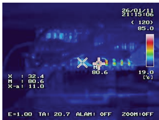
Rys. 2.42. Rozkład temperatury radiatora dla sterowania metodą klasyczną
