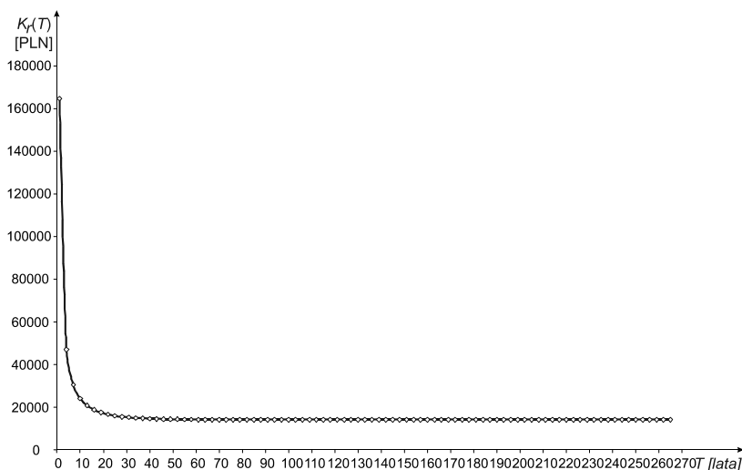
Rys. 3.63. Średni roczny koszt użytkowania 1 km linii kablowej SN o izolacji papierowo-olejowej w zależności od lat jej eksploatacji
