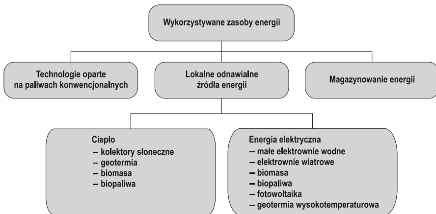
Rys. Z2.1. Podział źródeł generacji rozproszonej ze względu na rodzaj wykorzystywanych zasobów energii pierwotnej
