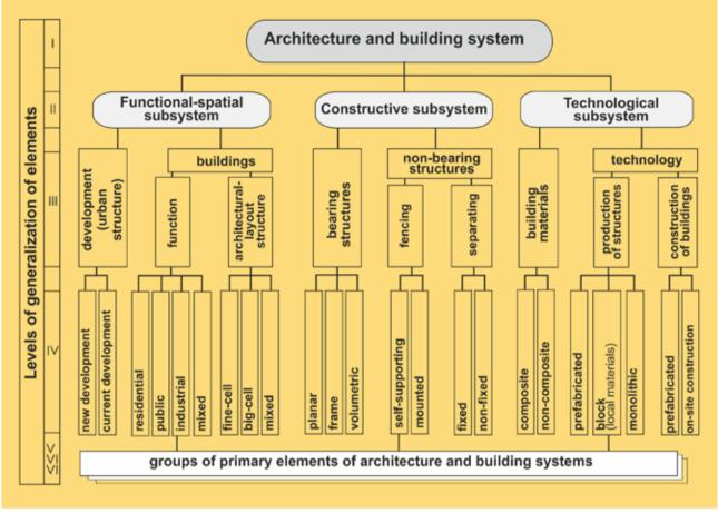
*Fig. 2. The structure of Architecture-&-Building System model Rys. 2. Struktura modelu systemów architektonicznych i budowlanych*
