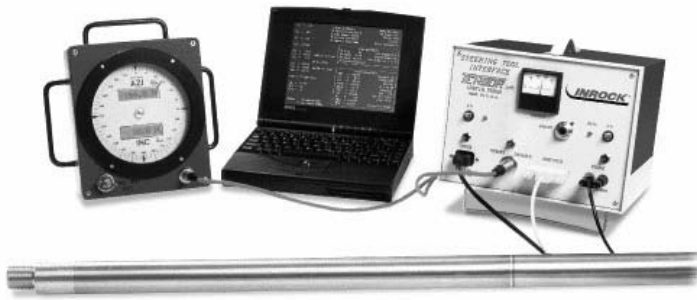
Rys. 4.6. Elementy magnetycznego systemu pomiarowego, [31]
