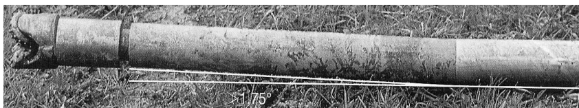
Rys. 2.27. Świder trójgryzowy z krzywym łącznikiem, [73]
