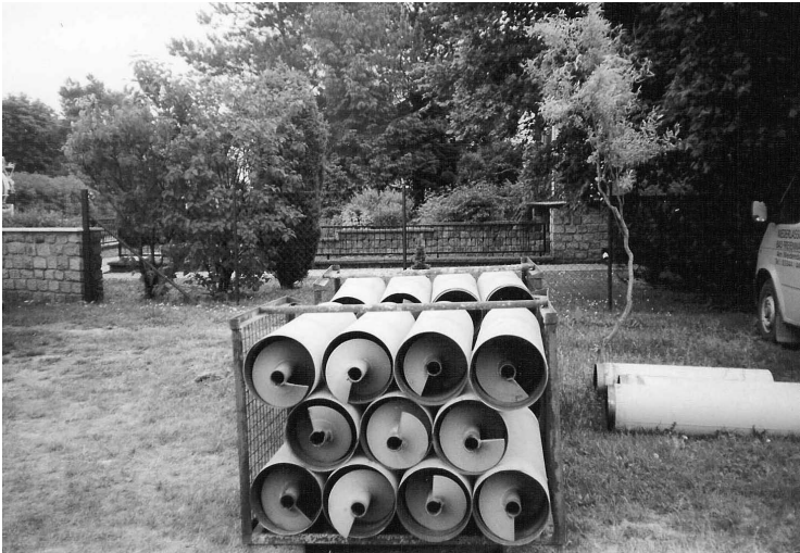
Rys. 2.63. Stalowe rury osłonowe z założonymi elementami przenośnika ślimakowego (zdjęcie własne dzięki uprzejmości firmy PERFORATOR)
