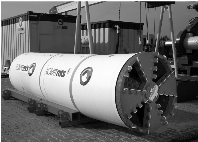
Rys. 2.80. Głowica do mikrotunelowania, [52]
