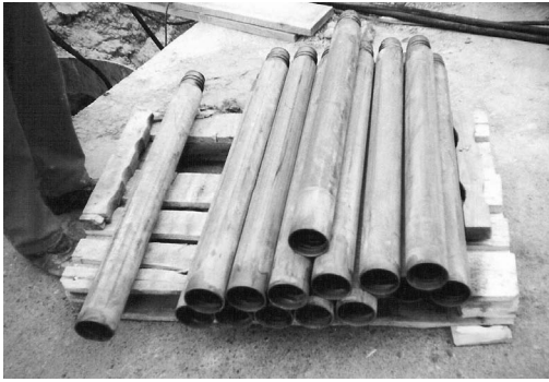
Rys. 2.57. Żerdzie wiertnicze przygotowane do przecisku (zdjęcie własne dzięki uprzejmości firmy PERFORATOR)
