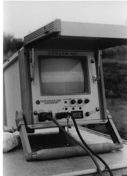
Rys. 2.60. Monitor, na którym wyświetlany jest obraz diodowej tablicy celowniczej (zdjęcie własne dzięki uprzejmości firmy INKOP)
