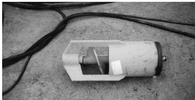
Rys. 2.61. Rozwiertak (poszerzacz) z elementem przenośnika ślimakowego (zdjęcie własne dzięki uprzejmości firmy PERFORATOR)
