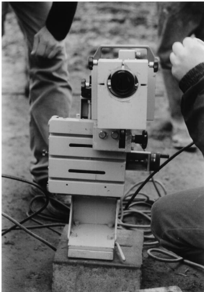
Rys. 2.59. Teodolit z wbudowaną kamerą cyfrową (zdjęcie własne dzięki uprzejmości firmy INKOP)
