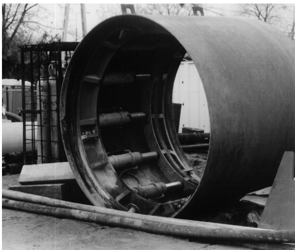
Rys. 2.101. Pośrednia stacja przeciskowa (zdjęcie własne dzięki uprzejmości firmy HYDROBUDOWA – 9 Poznań)
