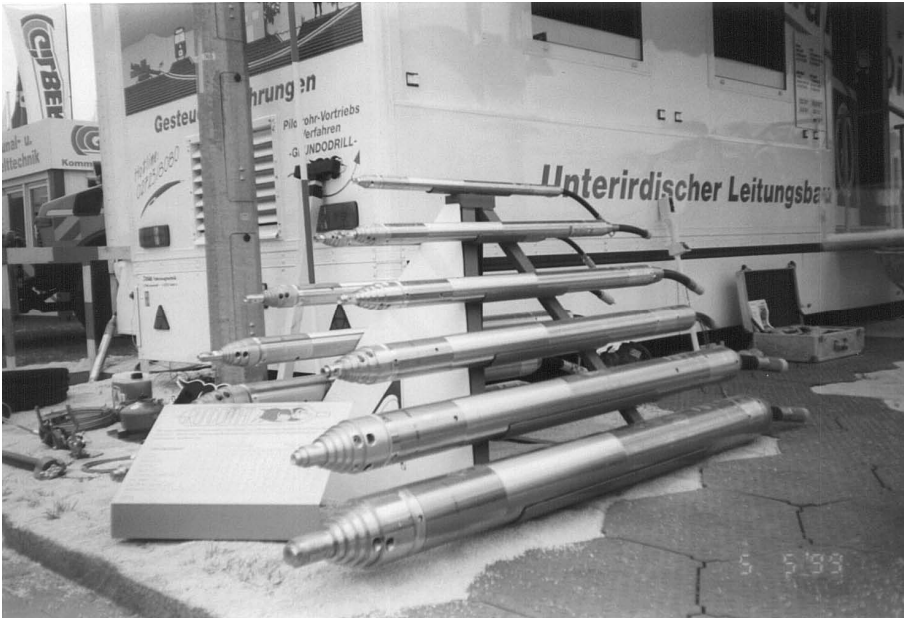
Rys. 2.2. Przebijaki pneumatyczne (zdjęcie własne dzięki uprzejmości firmy TRACTO-TECHNIK) Fig. 2.2. Impact moles (photo courtesy of TRACTO-TECHNIK firm)
