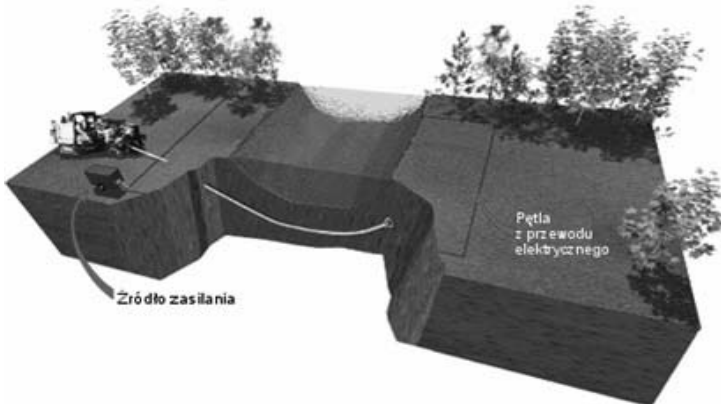
Rys. 4.7. Lokalizacja sondy w polu magnetycznym wytworzonym przez pętlę przewodową, [31]
