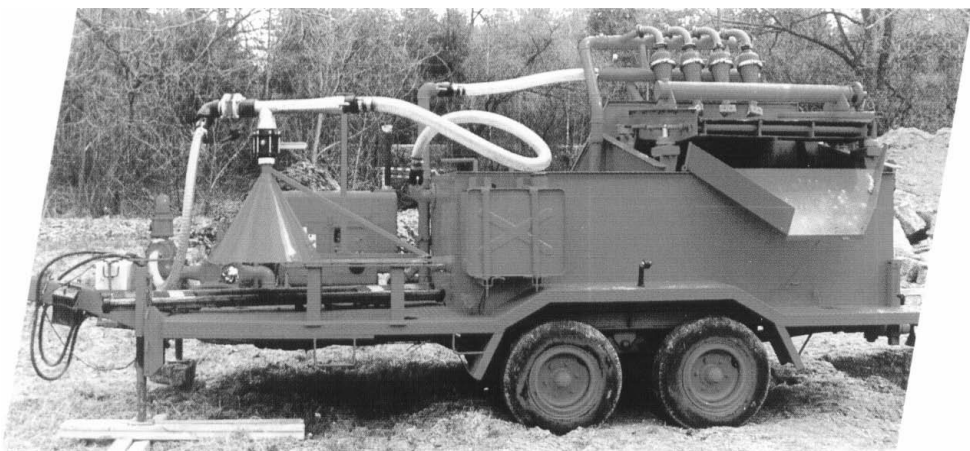
Rys. 2.44. Urządzenie służące do separacji płuczki na podwoziu kołowym, [73] Fig. 2.44. A plant for separation of drilling fluid from soil, [73]
