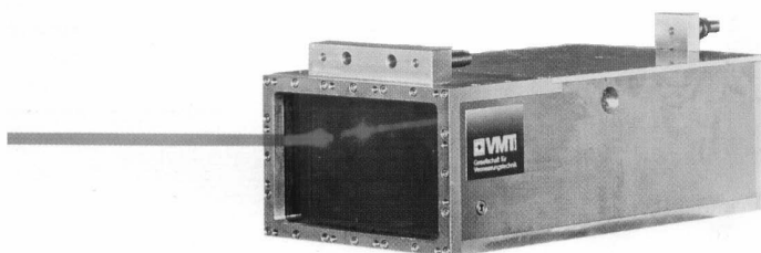
Rys. 4.17. Elektroniczny odbiornik wiązki laserowej z aktywną tarczą celowniczą, [76]
