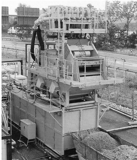
Rys. 2.45. Zespół urządzeń służących do separacji płuczki, [66]
