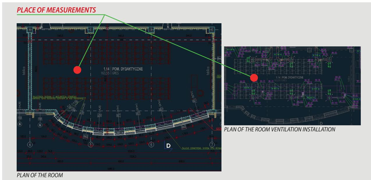
Fig. 3. Schematic of the room and the location of measurements (plan of the building adopted from: Puchala A., *Budynek Laboratoryjno-Dydaktyczny Wydziału Inżynierii Środowiska Politechniki Świętokrzyskiej "Energis", Rzut I piętra Wentylacja i Klimatyzacja*, 2010)
