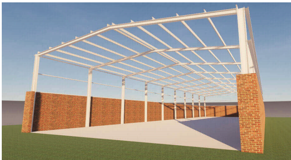
Rys. 5.1. Konstrukcja hali o układzie ramowym [90]
