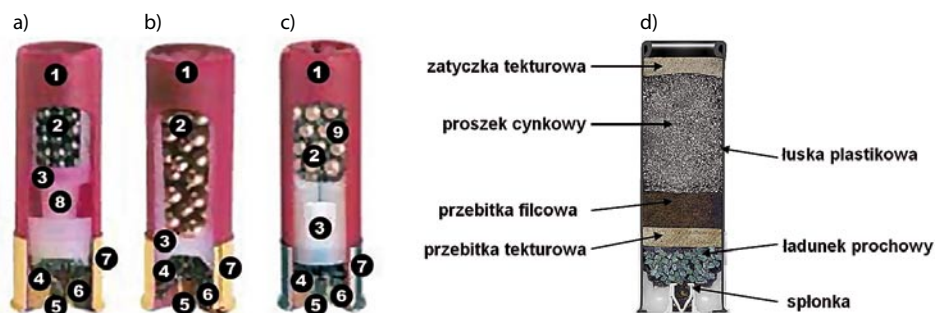
Rys. 58. Schemat budowy naboju śrutowych do strzelb gładkolufowych: ze śrucinami: a) ołowianymi, b) stalowymi, c) ze stopu wolframu z żelazem [70], dzięki uprzejmości Federal Cartridge Company oraz d) naboju proszkowego, dzięki uprzejmości Dynamit Nobel AmmoTec; oznaczenia: 1 – łuska, 2 – śruciny, 3 – przybitka, 4 – ładunek prochowy, 5 – spłonka, 6 – przybitka, 7 – obudowa metalowa łuski, 8 – koszyczek, 9 – proszek amortyzujący zderzenia śrucin
