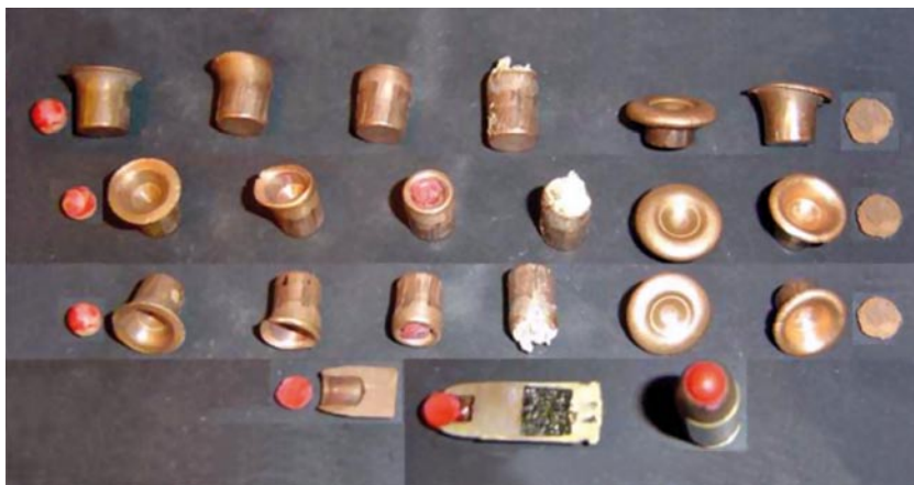
Rys. 16. Zdjęcie pocisku naboju niemieckiej firmy MEN 9×19 mm QD1 po zderzeniu z celem oraz przekrój i widok naboju (w dolnej części) [83], dzięki uprzejmości Jordi Camerón Vinaixa, http://www.municion.org
