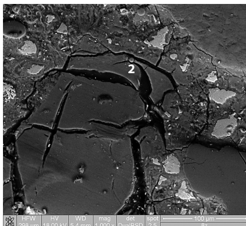
Rys. 8.43. a) Mikrostruktura żelu krzemianu wapniowo-sodowo-potasowego w zaprawie z cementu portlandzkiego bez dodatków mineralnych; b) analiza w mikroobszarze 1, próbka 5.
