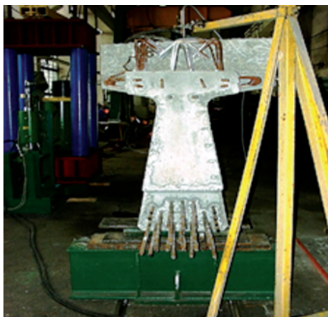
Fot. 16. Widok czoła belki wraz ze zbrojeniem.
