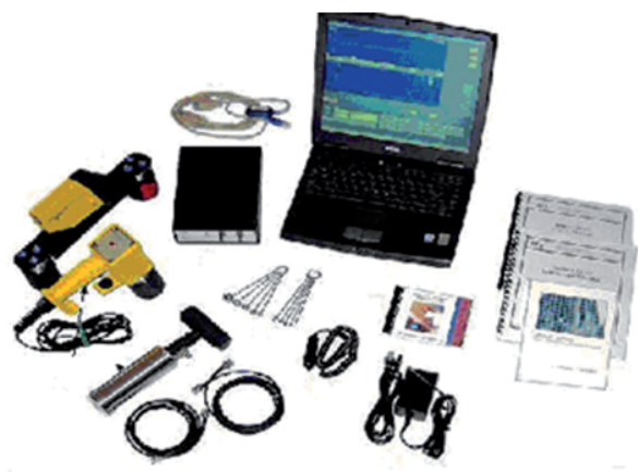
Fot. 10. Przykład kompletu aparatury badawczej do badań ultradźwiękowych metodą „ impact-echo ” wraz z oprzyrządowaniem.
