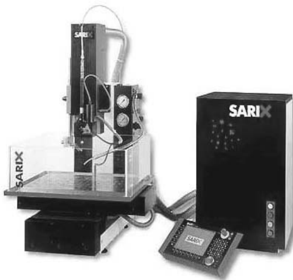
Rys. 5.14. Widok obrabiarki \mu -EDM Sarix SX-100 HPM; wymiary stołu roboczego: 530x270 mm; przesuw w osiach X, Y, Z, i W(ZZ)-150 mm; prędkość posuwu w osi Z – max 650 mm/min; prędkość posuwu w osiach X i Y – max 800 mm/min; dokładność pozycjonowania \pm 2 \mu\text{m} ; rozdzielczość – 0,1 \mu\text{m} ; waga przedmiotu – 20 kg; wymiary obrabiarki 650x600x900 mm
