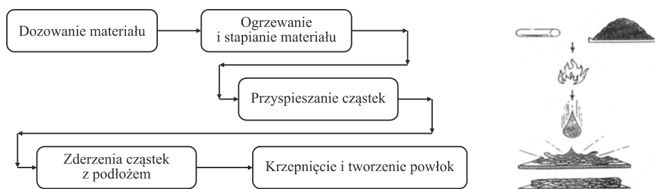
Rys. 4.1. Etapy procesu natryskiwania cieplnego
