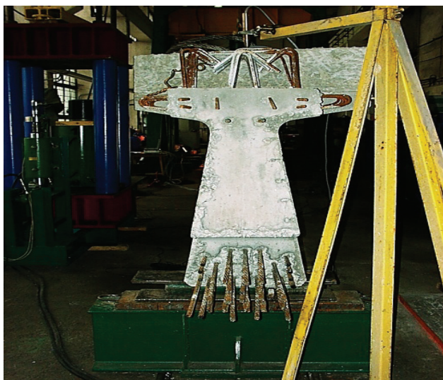
Rys. 5.2. Widok czola belki wraz ze zbrojeniem
