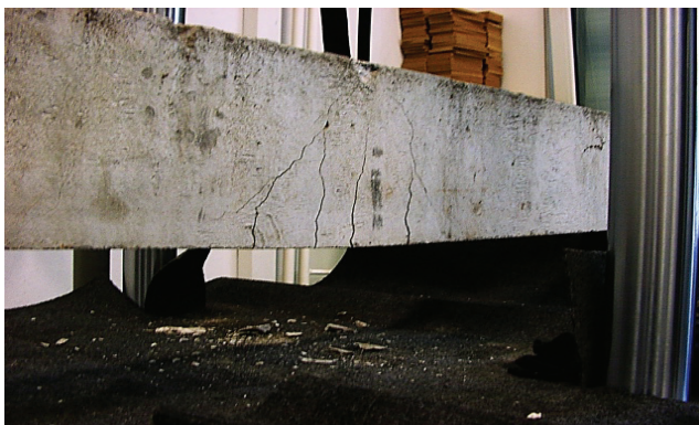
Rys. 3.11. Widok belki z rysami przy obciążeniu sięgającym 0,5 siły niszczącej
