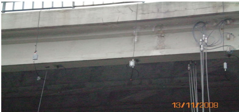
Rys. 6.23. Rozmieszczenie czujników wraz z przedwzmacniaczami oraz tensometrów
