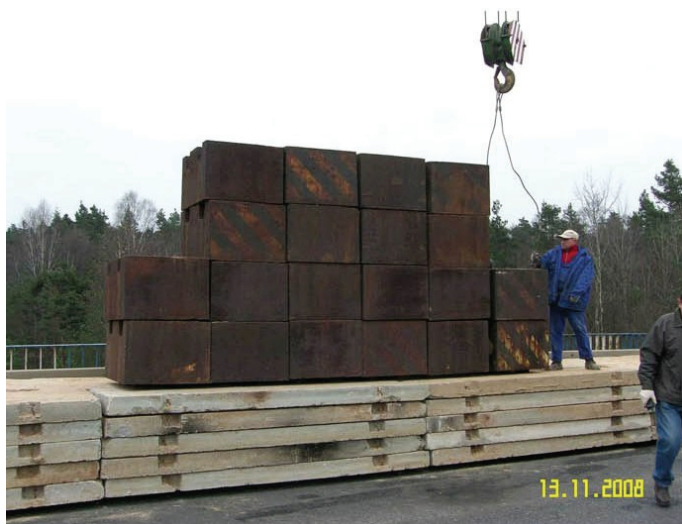
Rys. 6.24. Maksymalny poziom obciążenia w chwili zniszczenia belki
