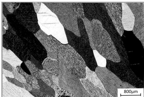
Rys. 72. Mikrostruktura: a) czystego magnezu, b) magnezu modyfikowanego cyrkonem 0,56%. Widoczny efekt rozdrobnienia ziarn czystego magnezu przez wprowadzenie cyrkonu. Temperatura modyfikacji 765°C [225]
