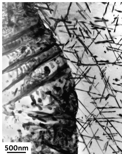
Rys. 58. Mikrostruktura stopu MgAl_9Zn_1 po starzeniu w temperaturze 200^\circ C w czasie 4 h. Widoczna struktura komórkowa – wydzielenie nieciągłe, oraz wydzielenia ciągłe [144]
