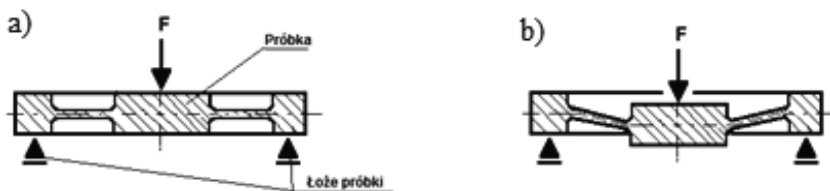
Rys. 20. Schemat zmiany kształtu obszaru pomiarowego z płaskiego (a) na stożkowy (b) po pełzaniu w czasie t
