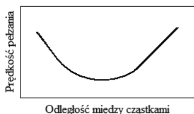
Rys. 15. Schemat zależności prędkości pełzania ustalonego od odległości między cząstkami fazy umacniającej [80]
