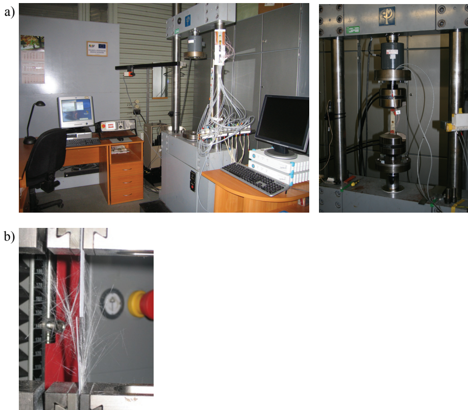
Rys. 7.9. Maszyny wytrzymałościowe: a) MTS 5T 50 kN, b) Zwick/Roell
