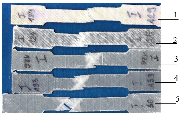
Rys. 6.11. Działanie środowiska korozyjnego i różnych związków chemicznych: 1 – \text{NaOH} , 2 – \text{H}_2\text{SO}_4 , 3 – \text{HNO}_3 , 4 – \text{H}_2\text{O} , 5 – próbka „dziewicza – sucha” [51] na strukturę kompozytu C
