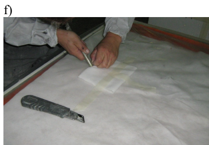
Rys. 7.5. Etapy formowania kompozytu na osnowie poliestrowej [0/90/0/90]: a) wycięcie i przygotowanie komponentów laminatu; b) przygotowanie półki uszczelniającej o szerokości 10-15 cm, na której przy pomocy specjalnej taśmy uszczelnia się membranę worka próżniowego; c) nałożenie jednej i pozostałych warstw tkaniny jednokierunkowej przesączając je za każdym razem; d) materiał delaminacyjny i materiał przepuszczalny oddychający; e) materiały zostają umieszczone w worku próżniowym ze specjalnej folii sklejęcej dwustronnie taśmą uszczelniającą; f) membrana próżniowa z zamontowanym wentylem i opcjonalnie złączem do odczytu podciśnienia
