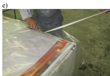
Rys. 7.5. Etapy formowania kompozytu na osnowie poliestrowej [0/90/0/90]: a) wycięcie i przygotowanie komponentów laminatu; b) przygotowanie półki uszczelniającej o szerokości 10-15 cm, na której przy pomocy specjalnej taśmy uszczelnia się membranę worka próżniowego; c) nałożenie jednej i pozostałych warstw tkaniny jednokierunkowej przesączając je za każdym razem; d) materiał delaminacyjny i materiał przepuszczalny oddychający; e) materiały zostają umieszczone w worku próżniowym ze specjalnej folii sklejęcej dwustronnie taśmą uszczelniającą; f) membrana próżniowa z zamontowanym wentylem i opcjonalnie złączem do odczytu podciśnienia
