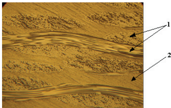
Rys. 6.6. Struktura kompozytu warstwowego: 1 – włókna, 2 – osnowa
