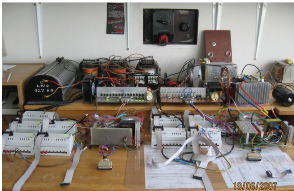
Rys. 7.2.22. Stanowisko laboratoryjne - prostownik Vienna
